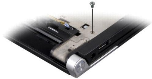
4. 将计算机翻转过来使其上部朝上，然后卸下将光盘驱动器固定到计算机系统板的三颗螺钉。
